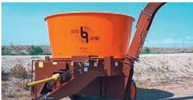
**Roto Grind 1090 Standard ASR:** Roto Grind Strohmühle, mahlen von Rund-Quarderballen oder loses Material, trockener Mist, stationär oder als Einstreumaschine. 40-6[...], Preis auf Anfrage
