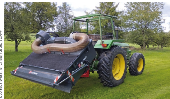
Das Prüfungsprojekt von Jungmeister Paul Stürzenhofäcker war ein Laubsauger mit hydraulischer Kippmulde.
