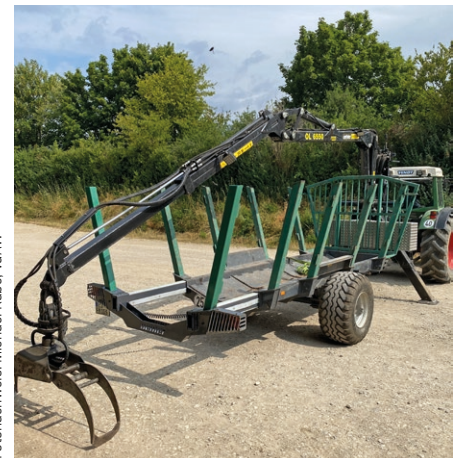
Jungmeister Clemens Kraft konstruierte einen hydraulisch ausziehbaren Rückewagen.
